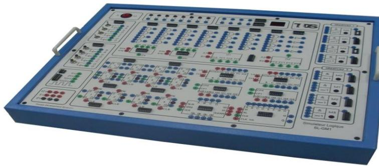
Ce TP de Circuits Logiques a pour objectif de se familiariser avec les différentes structures de la logique combinatoire et séquentielle.
