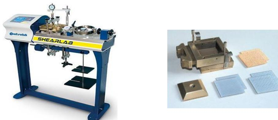
Ce laboratoire permet de réaliser les TP de Mécanique des Sols. Le but de cet essai est de déterminer les caractéristiques mécaniques d'un sol à la rupture.
